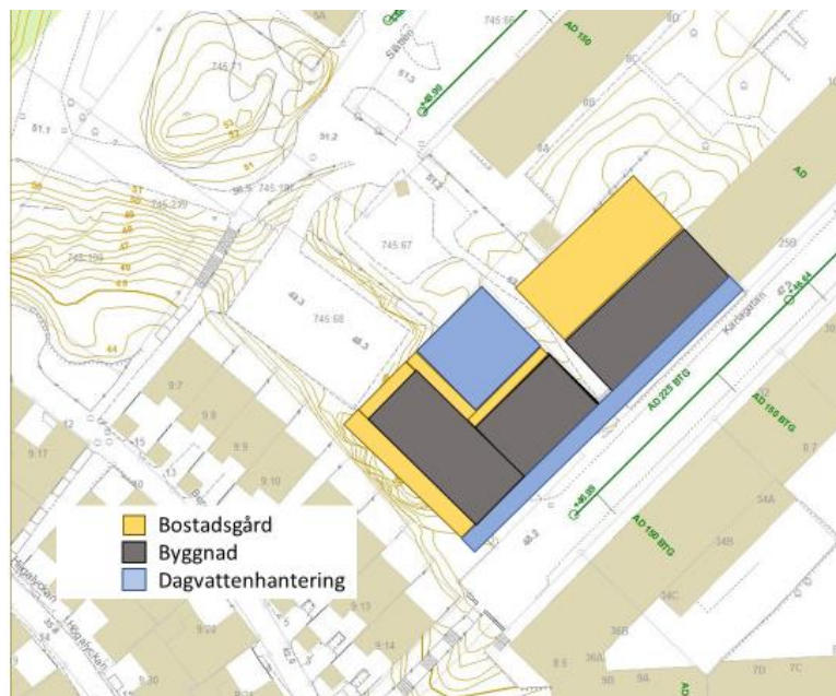
Figur 13. Schematisk Placering av dagvattenhanteringsanläggningar (blått) inom kvartersmark
